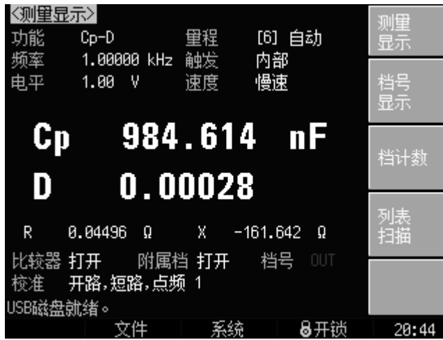
第 7 步 查看测试结果 图 14-2 电容器的测试结果
