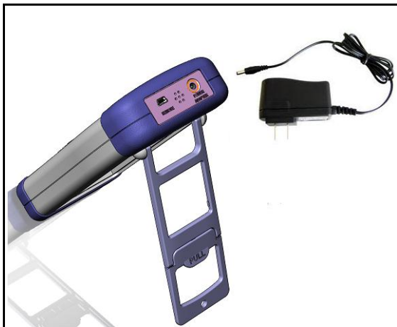
图 3-4 外部电源适配器与仪器连接
