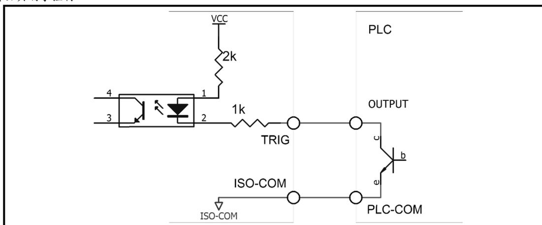
图 8-7 使用 PLC 正公共端子控制
