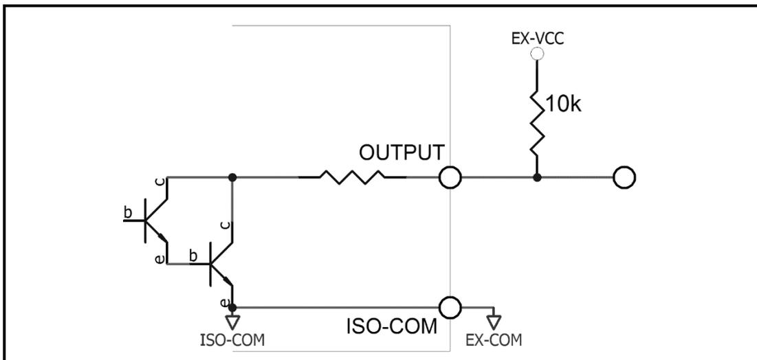
图 8-11 双端口输出组成逻辑或电路
