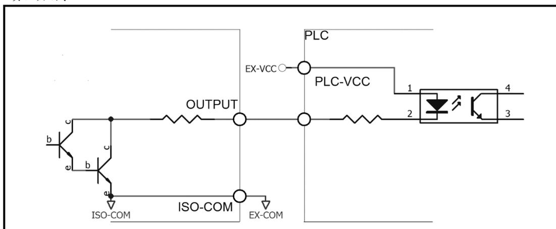
图 8-13 输出到 PLC 正公共端子
