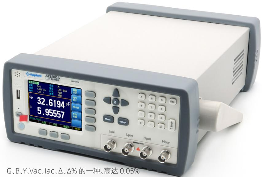
G、B、Y、Vac、Iac、 $\Delta$ 、 $\Delta\%$  的一种。高达 0.05% 的准确度使本仪器可满足各元件厂家学校、研究所和计量质检部门进行精确测试和批量生产的要求。
