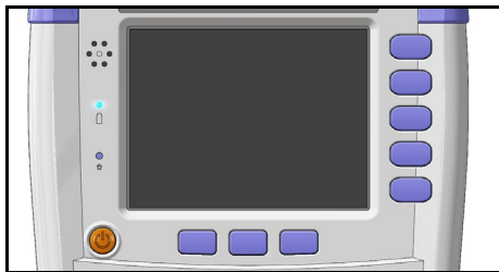
图 3-3 充电指示灯，充电时显示为蓝色
