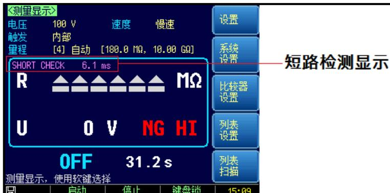
5. 短路检测完成后会显示检测时间，例如上图显示的 6.1ms。使用多个产品检测来获得一个最大时间，适当增加余量输入到短路检测定时器中。
