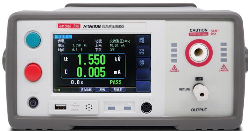
■ 电源要求 电压: 110VAC ~ 220VAC 频率: 50~60Hz 功率: 300VA
