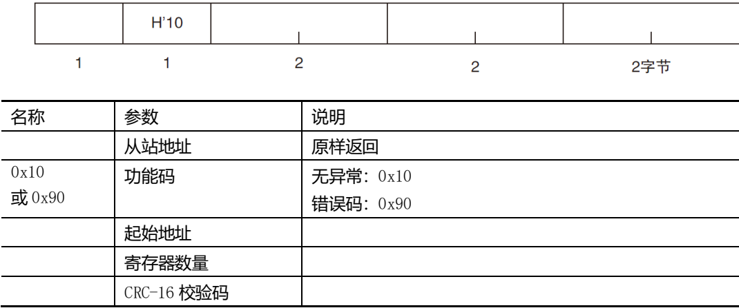
图 11-8 写入多个寄存器（0x03）响应帧 从站地址 功能代码 写入开始地址 元素数量 CRC-16
